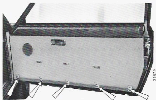
Smontaggio pannello rivestimento porta.
